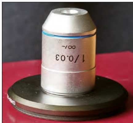
Abbildung 3: Preisgünstiges No-Name-Mikroskopobjektiv (Abb.-Maßstab 1:1) mit RMS-Gewinde und Adapterring auf 52 mm zur Befestigung vor einem Teleobjektiv
