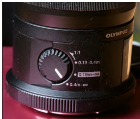
Abbildung 4: Das Olympus-Makroobjektiv 60 mm ED 1:2,8 bietet verschiedene Makro-Bereiche.
