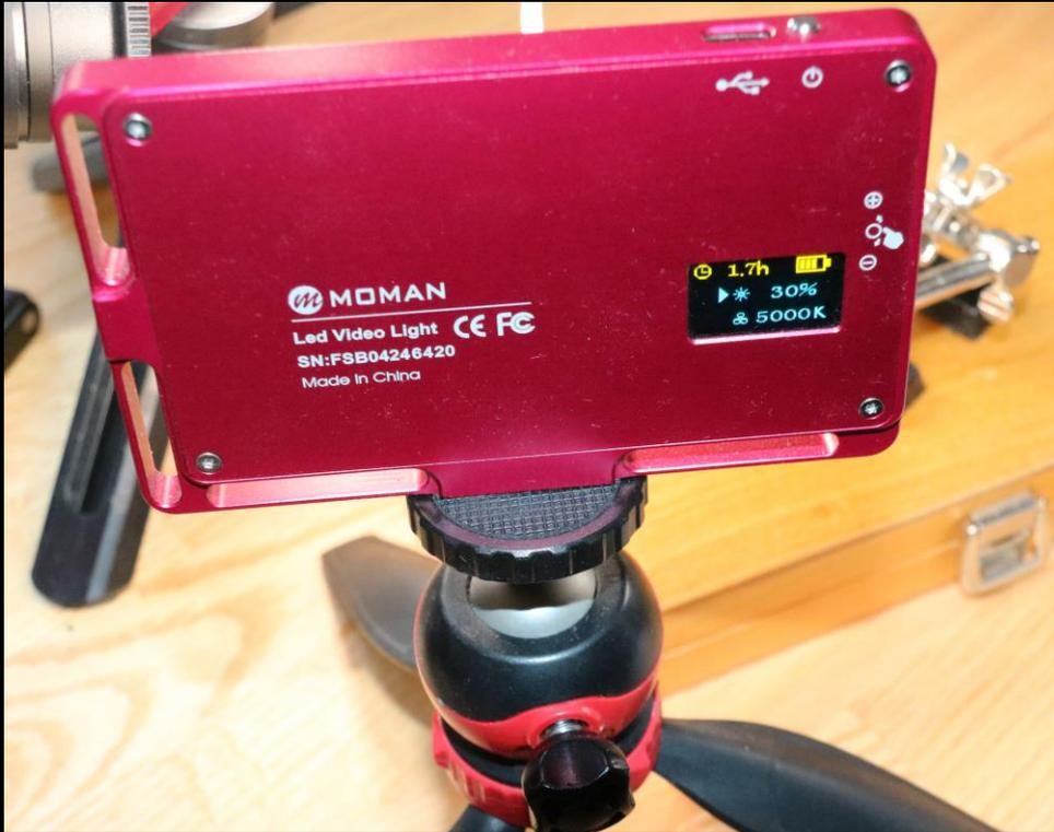
Videoleuchte, Akku (mit Restanzeige), USB-Ladekabel, zwei Stativgewinde
